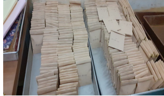
Gambar 7. Sampel yang telah dipreparasi menjadi mesh 200 yang kemudian disimpan di dalam pulp
