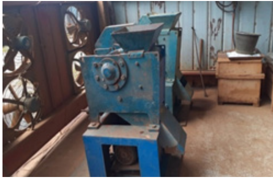
Gambar 3. Crusher dengan Ukuran Butir 2 mm
