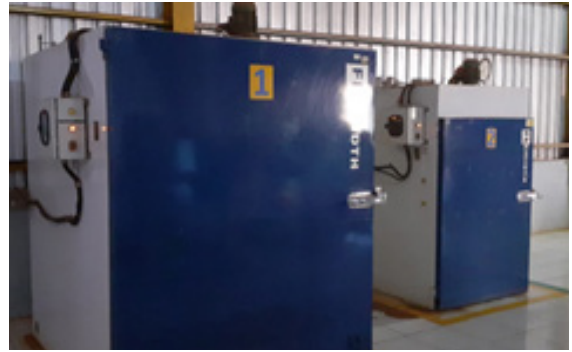
Gambar 2. Pengeringan Sampel dengan Menggunakan Oven
